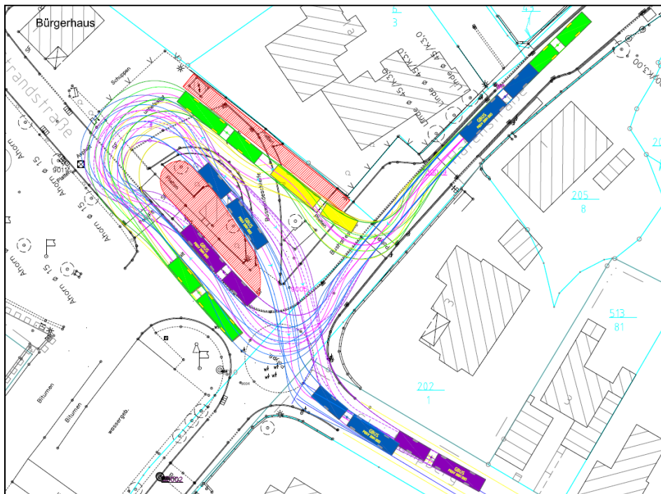
Bild 6.3: Umgestaltung des bestehenden ZOBs - Entwurfsskizze
