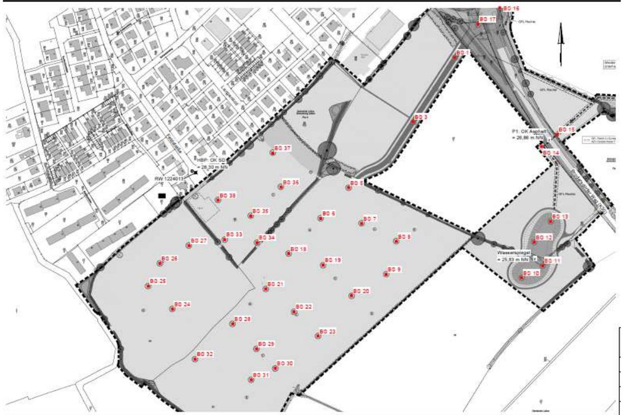
**Abbildung 7:** Lageplan der Bohrungen (MÜGGE 2017)
