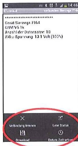
Zuerst werden Ihnen die Bluetooth-Nummer, die Anzahl der im Gerät gespeicherten Datensätze und die Akku-Spannung angezeigt.
