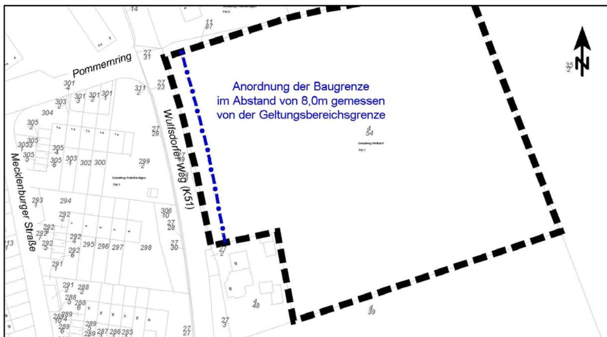
Bild 4.1: Möglichkeit 1 - Anordnung der Baugrenze
