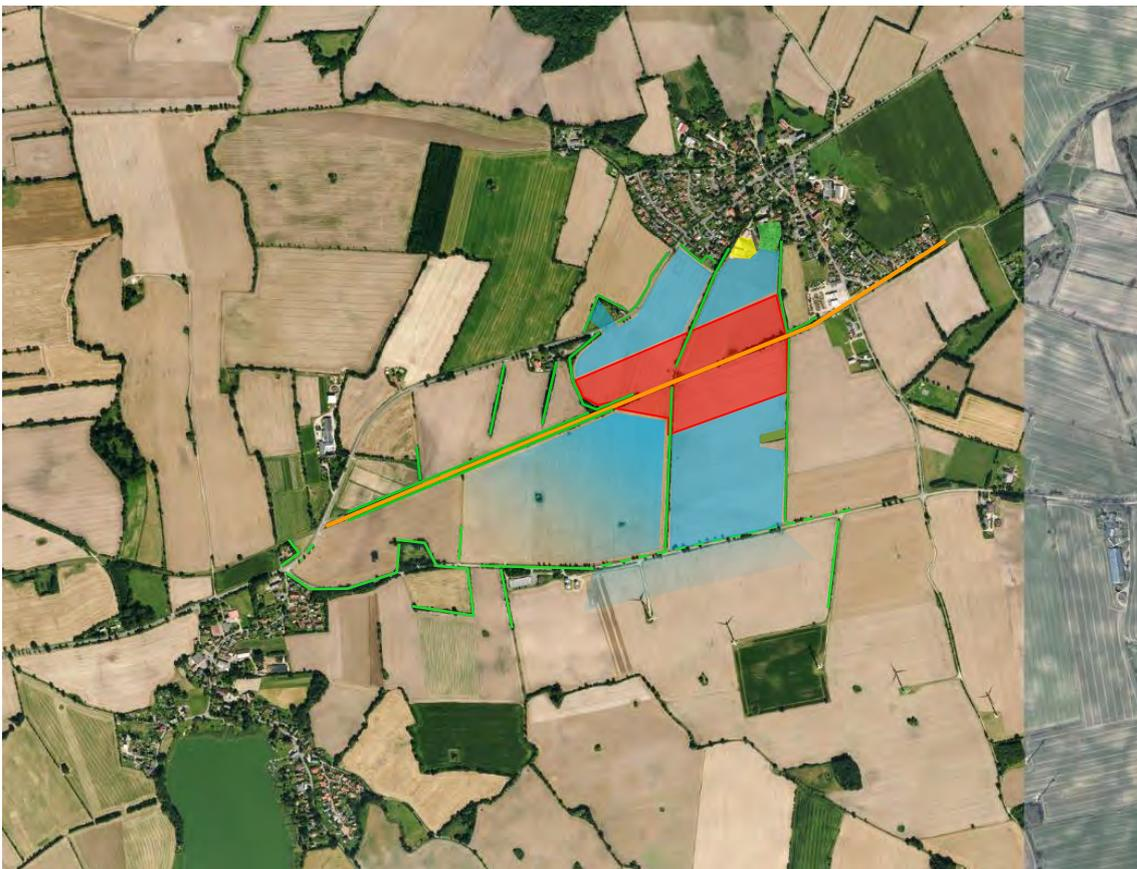
Abbildung 12: Darstellung der sichtverstellenden Elemente (grün-Grünstrukturen) und der vom Plangebiet (rot) ausgehenden, potenziell sichtbeeinträchtigten Fläche (blau – ungebauter Nahbereich, hellblau – geringfügig sichtbeeinträchtigte Fläche, orange = Bahntrasse, gelb = Landwirtschaftsbetrieb) Erläuterung im Text. Kartengrundlage: Luftbild DigitalerAtlasNord-SH 2018.
