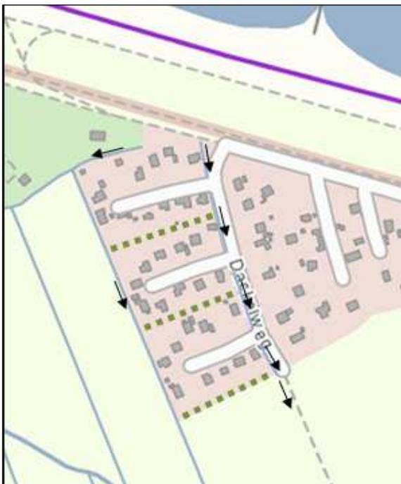
Entlang der äußeren Grenze sowie des Erschließungsweges verlaufen Entwässerungsrinnen, welche die Entwässerung des Plangebietes sowie der außen daran angrenzenden Flächen sicherstellen. Im inneren Bereich bilden Geländemulden und andere individuelle Lösungen der Grundstückseigentümer auf den rückwärtigen Grundstücksteilen zusammen mit den Gräben die Vorflut des Plangebietes. Das gesammelte Oberflächenwasser fließt im Süden in die Fernau ab.
